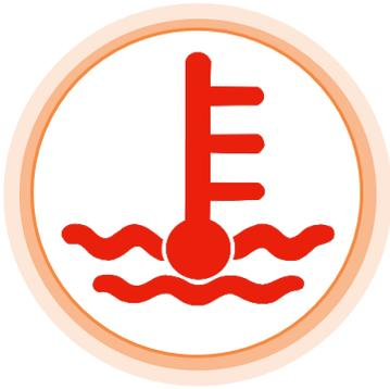
**Kühlmitteltemperatur** ist zu hoch, der Motor kann überhitzen. Eine mögliche Ursache könnte sein, dass zu wenig Kühlwasser vorhanden ist.
