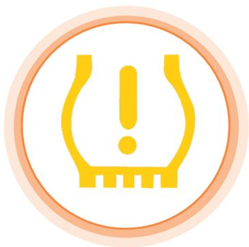
**Reifendruck-Kontrollleuchte (RDKS)** Warnhinweis, dass der Luftdruck zu gering ist oder der Wert nicht gespeichert wurde.
